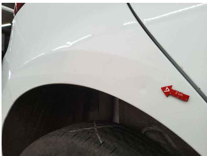
Bild 5: Außen, Seitenteil hinten rechts, Dellen , smart repair
