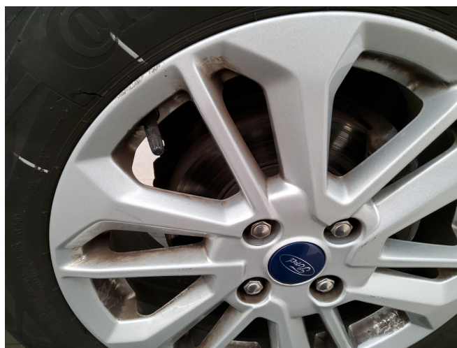
Bild 6: Außen, Felge vorne rechts, beschädigt , instandsetzen
