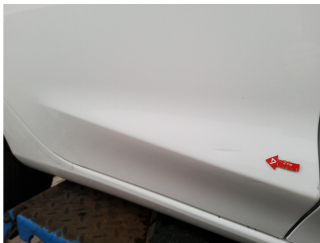
Bild 4: Außen, Tür hinten rechts, Delle, Kratzer , smart repair
