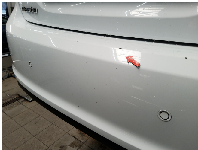
Bild 3: Außen, Stoßfänger hinten, Kratzer , lackieren
